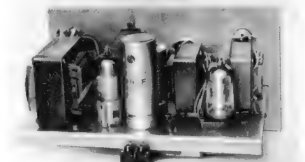
Bild 6b. Innenansicht; die Röhre rechts neben dem Netztransformator gehört zum Netzteil; rechts neben den Elektrolytkondensatoren der Zwischenübertrager, ganz rechts der Eingangübertrager
