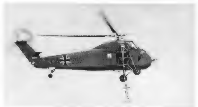
Bild 9. Sikorski-Hubschrauber der Bundeswehr als fliegende Relaisstation. Am Vorderteil die Empfangsantenne für die Verbindung mit dem Kamerawagen, unterhalb die Zweiebenen-Antenne für den Relaisender in Kanal 12
